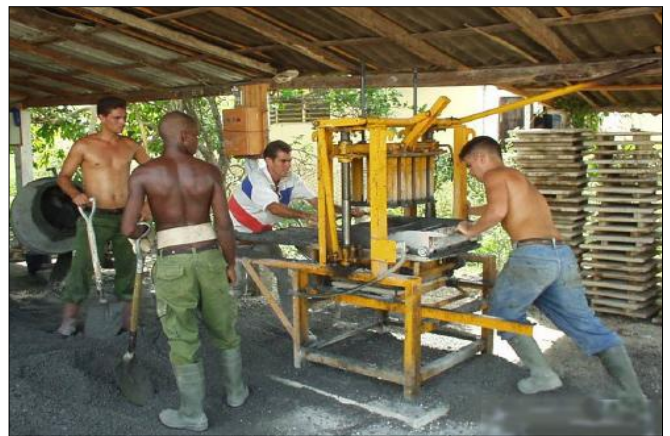
Producción de Bloques huecos a base de mezclas cal-puzolana
